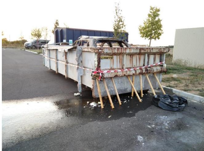
Photo 10\_ benne d'immersion du véhicule, étanchéifiée par la CMIC
